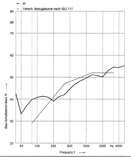
Bewertung nach ÖNORM EN ISO 717-1  $R'_{w}(C,C_{tr}) = 48 (0; -2) dB$  C<sub>50-3150</sub>: 0 dB C<sub>50-5000</sub> 1 dB
