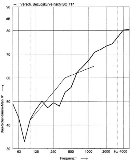
Bewertung nach ÖNORM EN ISO 717-1  $R'_{w}(C,C_{tr}) = 61 (-2; -6) dB$  C<sub>50-3150</sub>: -3 dB Ctr5o-315o: -10 dB
